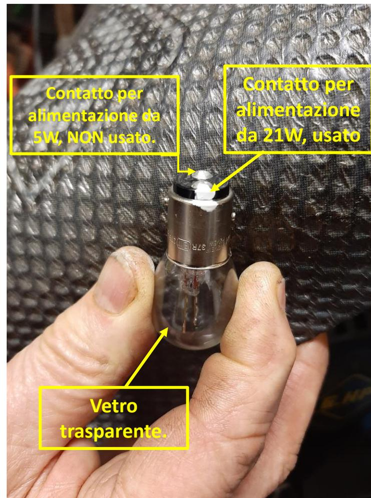
La lampadina della freccia è del tipo P21W 5W ma **VIENE ALIMENTATO SOLO IL FILAMENTO DA 21W DURANTE L'USO DELLA FRECCIA**
