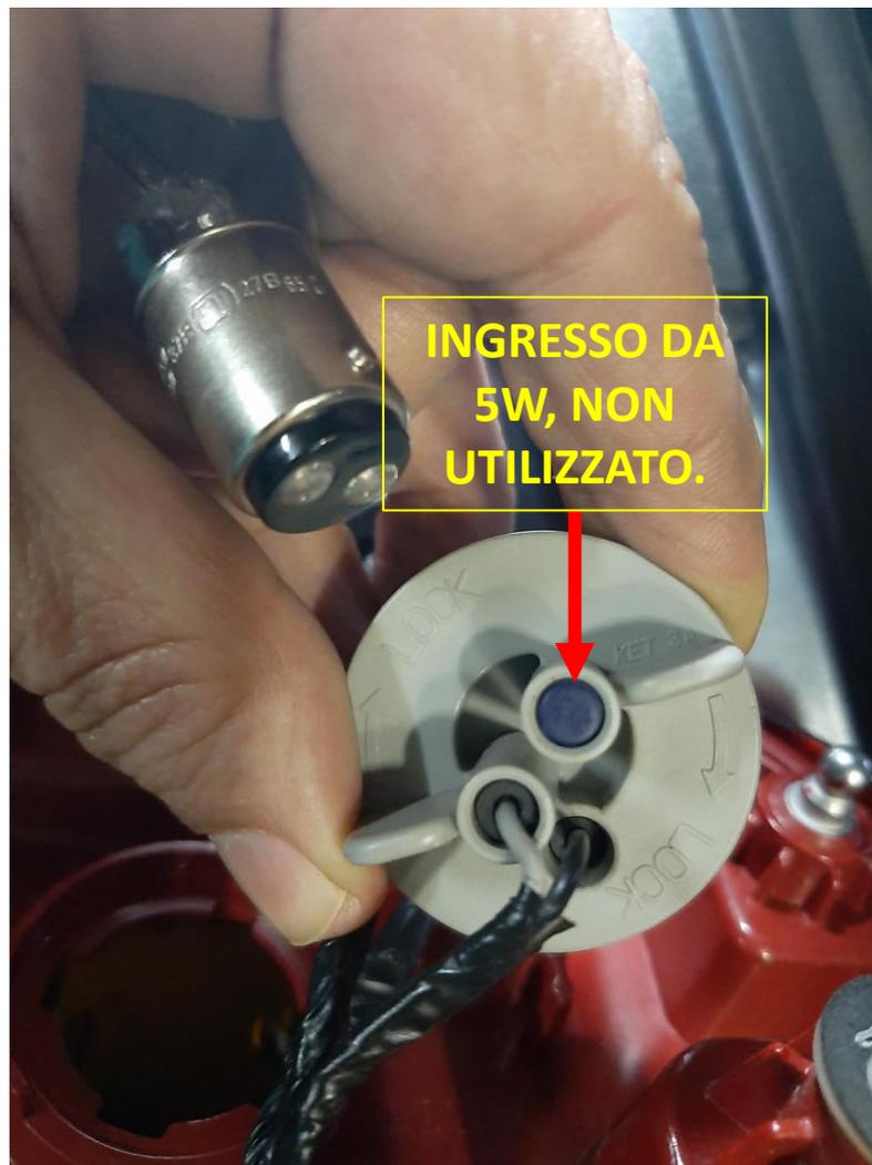
PARTE INFERIORE DEL PORTALAMPADA DELLA FRECCIA.
