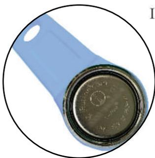
I dispositivi **iButton™** (tecnologia proprietaria di Dallas Semiconductor Inc.) forniscono una protezione più efficace del trasponder radio in quanto sono dispositivi a contatto (non “hackerabili” a distanza) e non riproducibili (ogni iButton™ possiede una chiave univoca e criptata a 128 bit). Per attivare e disattivare la protezione è necessario un contatto fisico.
