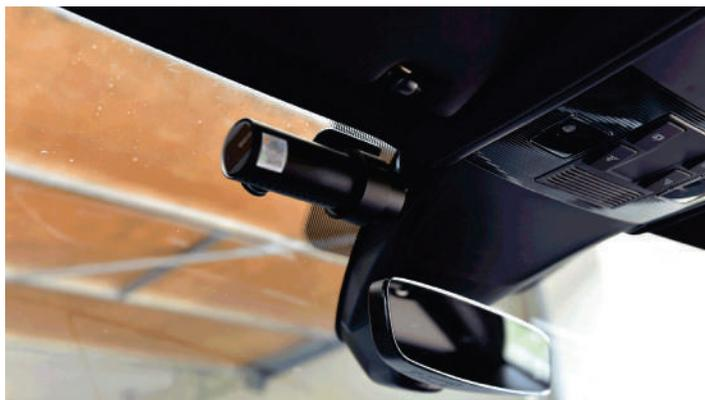
La Dashcam è un dispositivo utilizzato per registrare video in caso di incidente stradale. Solitamente viene installata sul parabrezza frontale del veicolo. I modelli più evoluti posseggono due camere integrate:
